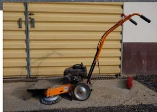
Nous avons acheté deux appareils un **désherbeur thermique à air chaud pulsé** et une **brosse mécanique**. Par contre, cela entraîne quelques inconvénients :
